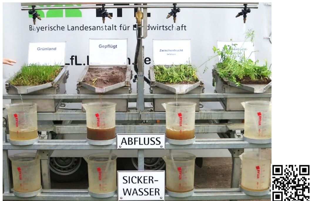
Abb. 11: Regensimulator: Einfluss der Bewirtschaftung auf Bodenabtrag und Oberflächenabfluss; Videolink zum Bild durch das Scannen des QR-Codes
